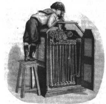
O funcionamento interno de um quinetoscópio de 1891, com um filme de 15 metros de comprimento que deslizava por uma série de roldanas e alimentava um visor.
